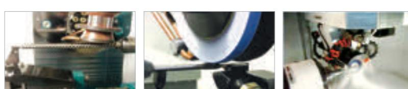
外圆清边 螺纹磨削 刀具修磨
