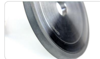
Hybrid kombiniert Metalleigenschaften mit Kunstharzeigenschaften. Diese Matrix besitzt exzellente Schleifscheibeneigenschaften mit hohem Verschleiss- und hoher Wärmebeständigkeit. Diese kombinierten Eigenschaften unterstützen die hohen Abtragsleistungen bei Hartmetallen und HSS. (Genentech GMT Serie)
