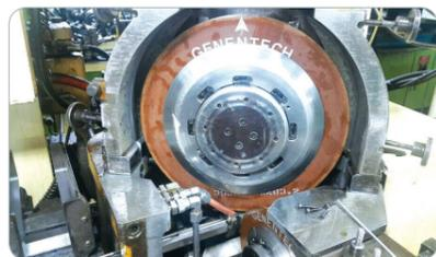
Diese Scheiben werden bei 180°C in Phenolharzbindung hergestellt.(verglichen mit anderen Bindungstypen eine relative niedrige Verarbeitungstemperatur)
